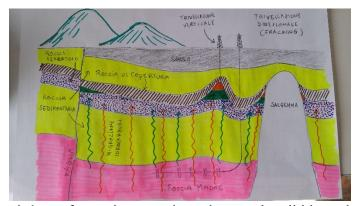
Figura 2. Struttura di un giacimento convenzionale di idrocarburi<sup>4</sup>
